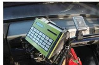
Equipo instalado del boleto electrónico en una unidad de la empresa Tairké de Río Grande.
